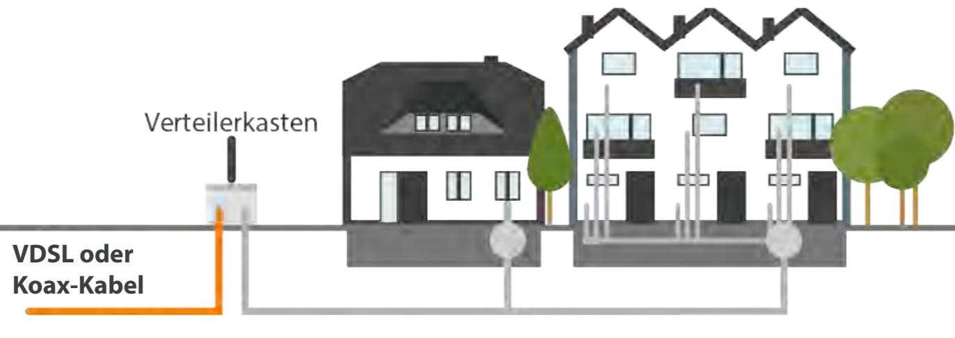
Glasfaser bis zum Verteilerkasten
